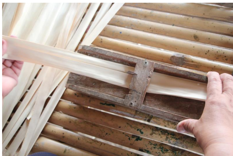
ภาพที่ ๑ เลียด ใช้สำหรับเจียนใบลานให้มีขนาดเท่ากัน
